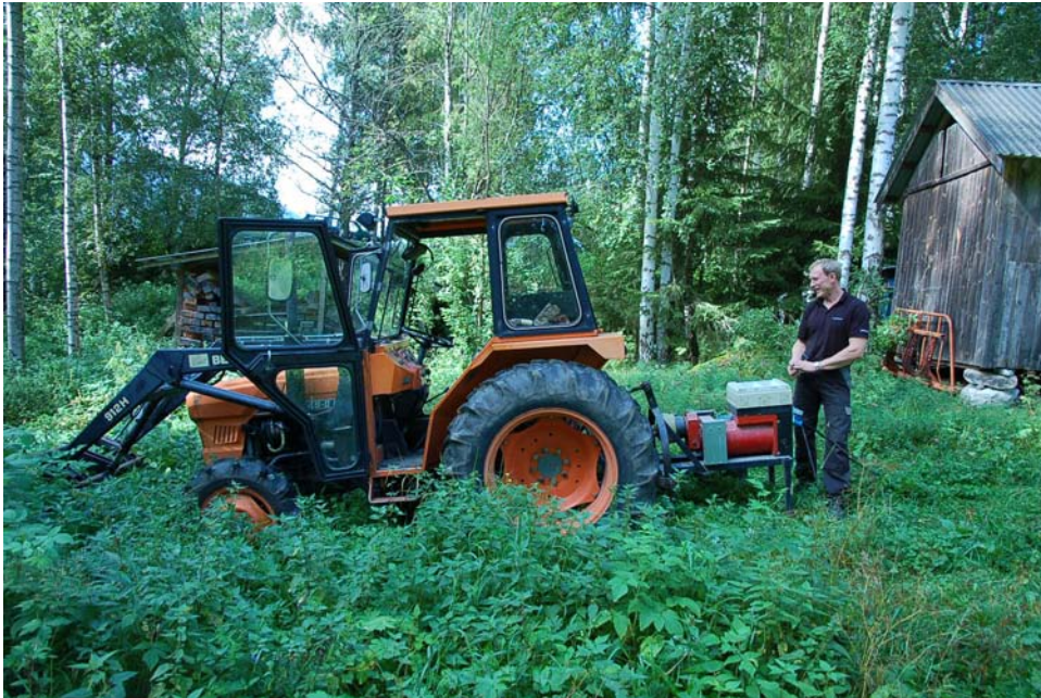
Foto 3. Aggregat på traktor som strømkilde.
